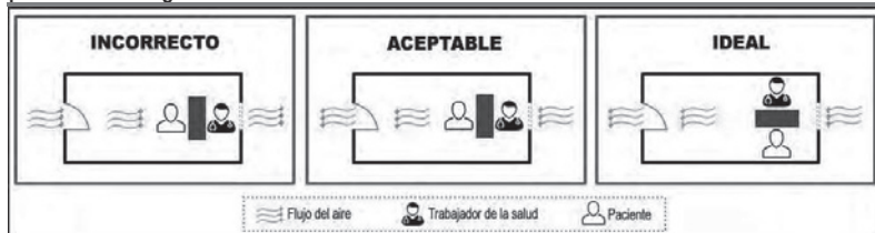
Figura 2. Dirección de la ventilación y ubicación del puesto de trabajo en las áreas de atención de personas con diagnóstico de tuberculosis
